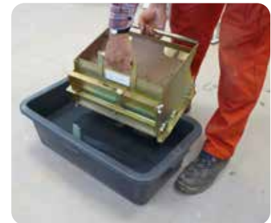
In längeren Arbeitspausen empfiehlt es sich, die Rolle im Wasserbad zu lagern, um ein Austrocknen des Mörtels zu verhindern.
