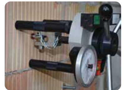
Typisches Zugerät zum Ermitteln der zentrischen Zuglasten. (Foto E. Scheller)
