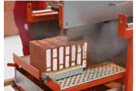
3 Im Trocken- oder Nassverfahren können Ausgleichsziegel in beliebiger Höhe geschnitten werden.
