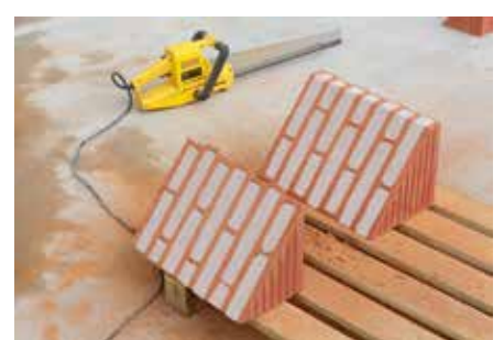
9 Schräg trocken geschnittener Ziegel.
