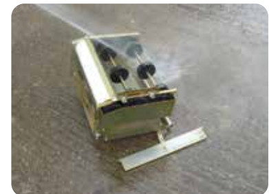
Nach Arbeitsende wird die VD-Mörtelrolle gründlich mit viel Wasser gereinigt.
