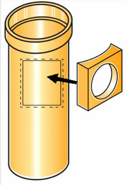
Mantelstein im Bereich der gewünschten Anschlusshöhe mit Winkelschleifer etc. öffnen.
