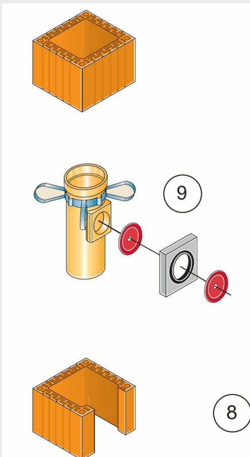
⑨ Anschlussmembrane in den Feuerstättenanschluss einbringen und anschließend Anschlussstein mit Anschlussmembrane mantelsteinbündig in den Mantelstein einmörteln. Dichtung im Anschlussstein entfällt bei raumluftabhängiger Betriebsweise.
